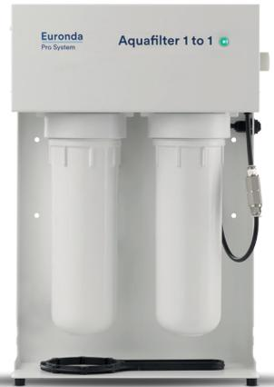
Dispositivo para producir agua desionizada para autoclaves, conforme a la norma EN 13060 (< 15  $\mu\text{S}/\text{cm}$ ). Permite suministrar agua a un solo autoclave Euronda Pro System. Desioniza una media de 1 litro de agua por minuto. Se puede equipar con un dispositivo de desconexión automática. Puede colocarse directamente en la superficie de trabajo, dentro del armario o fijado en la pared. El suministro inicial incluye 2 resinas de intercambio iónico.
