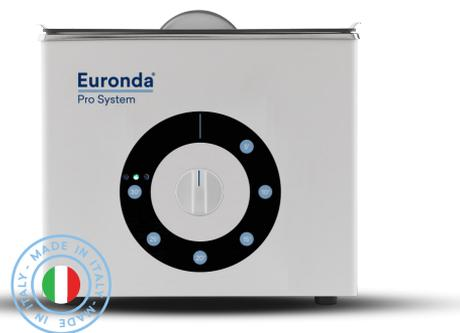
Cuba de ultrasonidos con temporizador mecánico que permite ajustar la duración del ciclo de limpieza de 5 a 30 minutos. Eurosonic Energy está equipada con la tecnología Sweep Mode que distribuye uniformemente las ondas ultrasónicas para una limpieza profunda y uniforme. Resistente, con armazón de acero inoxidable (AISI 304L) y tapa indeformable con sistema antigoteo, dispone de asas laterales para facilitar las operaciones de vaciado y un panel de control eficaz e intuitivo.
